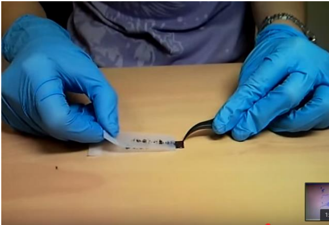
Figura 1.- De la pieza de grafito de alta pureza se van desprendiendo las monocapas con cinta adhesiva. Para comprobarlo se pasa la cinta a un microscopio electrónico. Aquí se puede ver el proceso completo.
